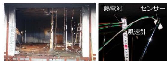
図1 区画の内観と天井下の測定器
