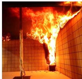
内装材の燃え拡がり
