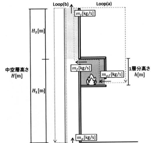
図 11 ダブルスキン計算モデル
