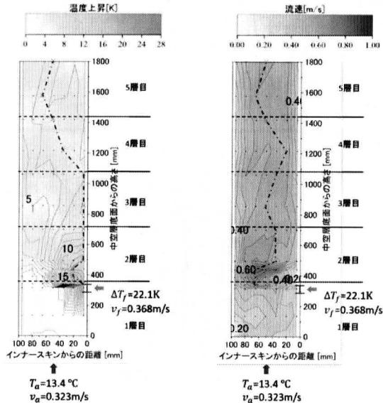
図3 中空層内鉛直温度・流速分布
