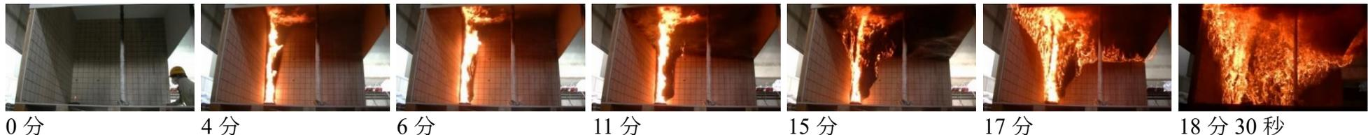
図2 厚さ 9mm の合板壁の燃焼拡大性状
