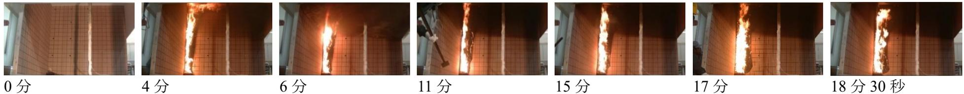
図1 厚さ 5.5mm の合板壁の燃焼拡大性状
