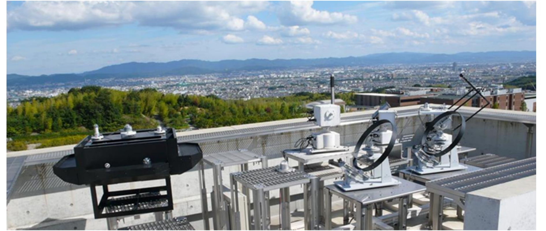
様々な昼光気象観測機器による測定(桂C1-3棟屋上)
